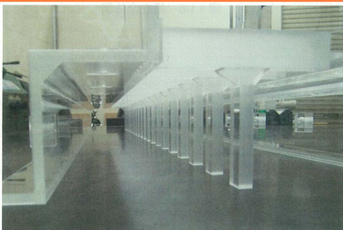
模型実験用掘削構造(1/100縮尺)
