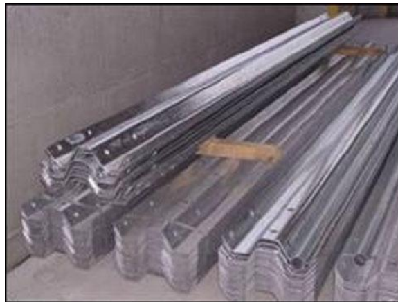
④亜鉛めっき後のガードレール
