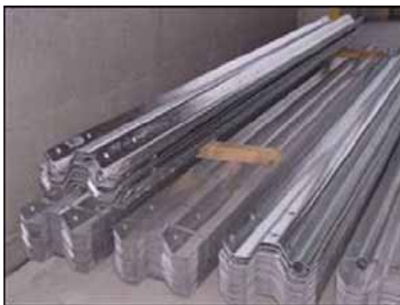
亜鉛めっき後のガードレール
