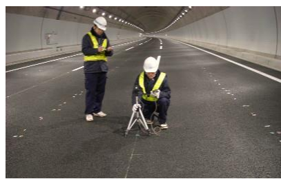
鉛直面照度の測定
