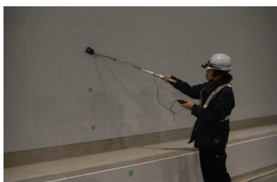
壁面照度の測定
