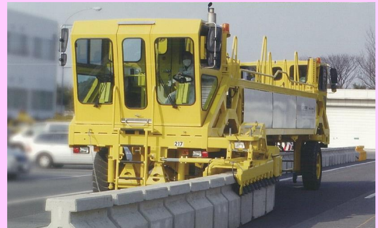
移動式防護柵切替用車両による防護柵移動状況
