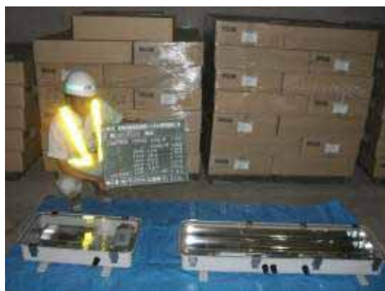
納入時の抜き取り検査 (灯具)
