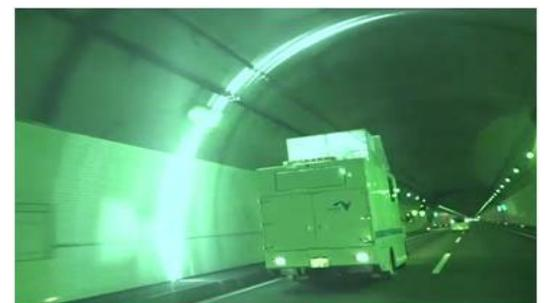
(移動式トンネル点検車による点検状況)
