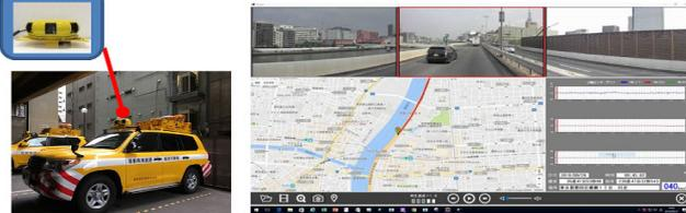
(高性能ドライブレコーダーを活用した路面損傷の自動検出)
