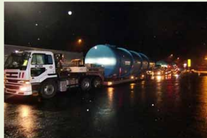
【汚染水処理のための超大型タンク(120m 3 )の搬送】
