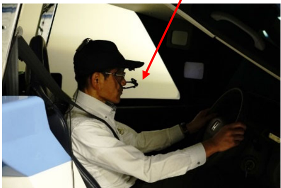
ドライビングシミュレーターによる試験状況 (アイマークテストを同時に実施)
