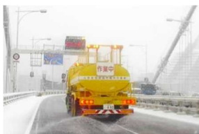
凍結防止剤の散布状況
