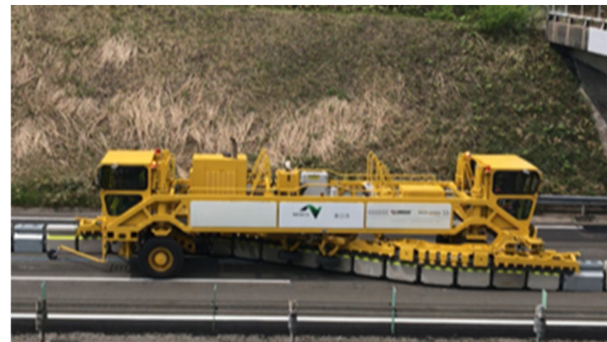
移動式防護柵移動状況
