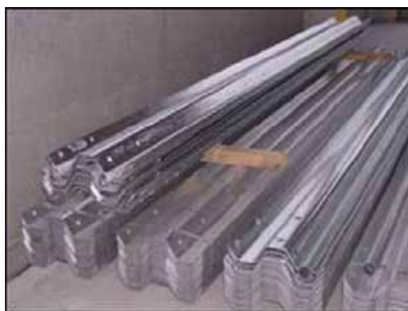
亜鉛めっき後のガードレール
